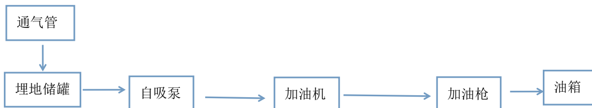
图 2.6-4 柴油加油工艺流程示意图
