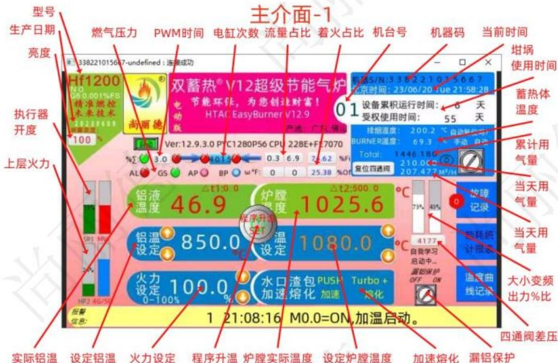
图 2.4-1 天然气自动浇注线操作控制台液晶显示屏显示图
