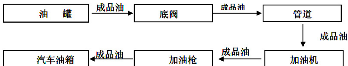
图 2.6-3 柴油加油工艺流程示意图
