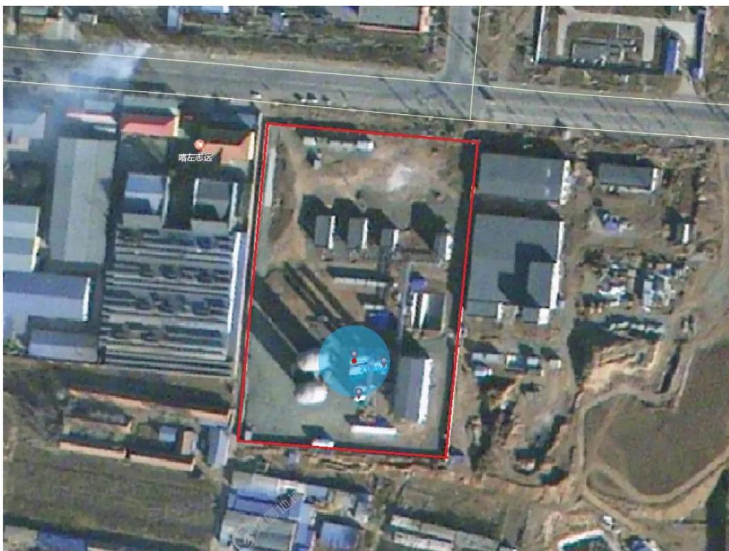
(2) 当目标装置类型为压力容器时半径为 25.2783 米，模拟图如下
