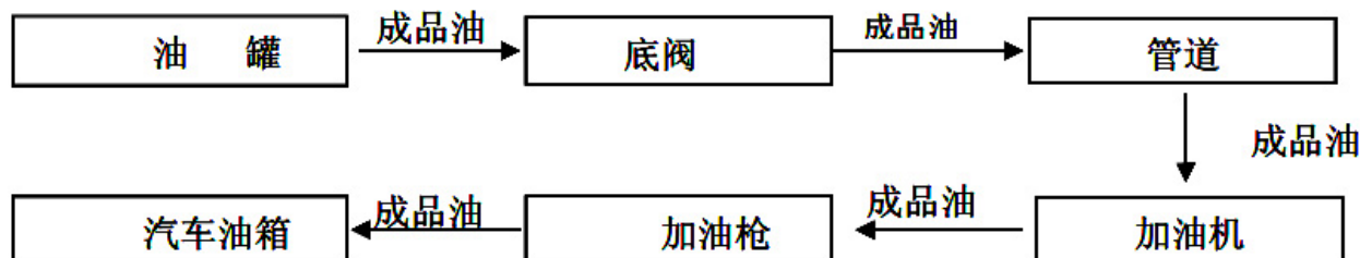
图 2.6-3 柴油加油工艺流程示意图
