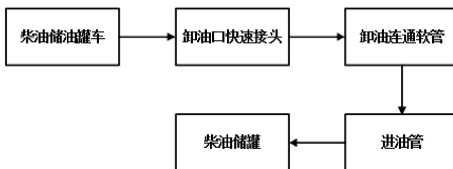
图 2.6-2 柴油卸油流程图
