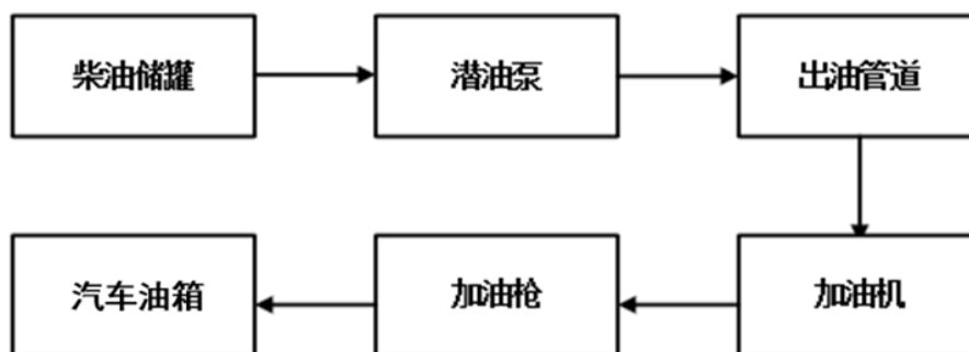
图 2.6-3 汽油加油流程图
