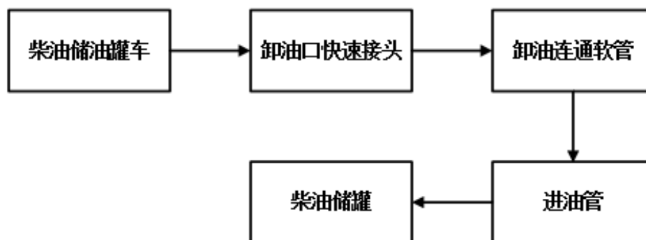
图 2.6-2 柴油卸油流程图
