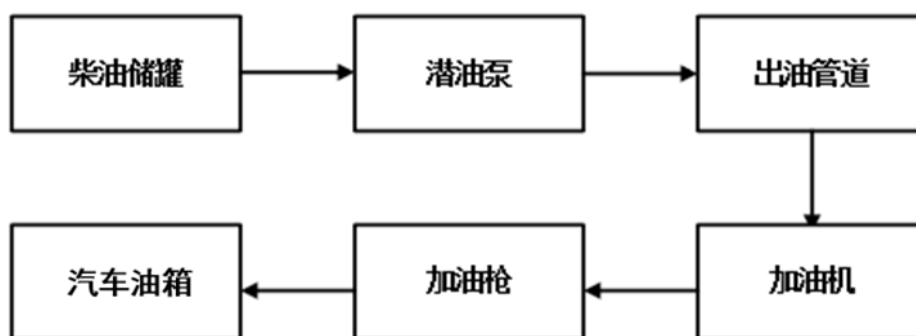
图 2.6-3 汽油加油流程图
