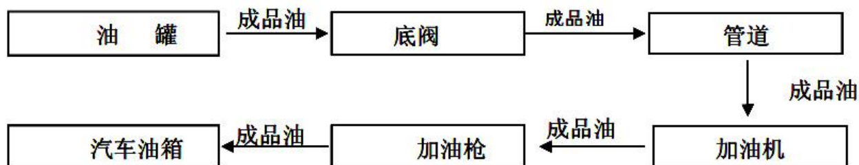
图 2.6-3 柴油加油工艺流程示意图
