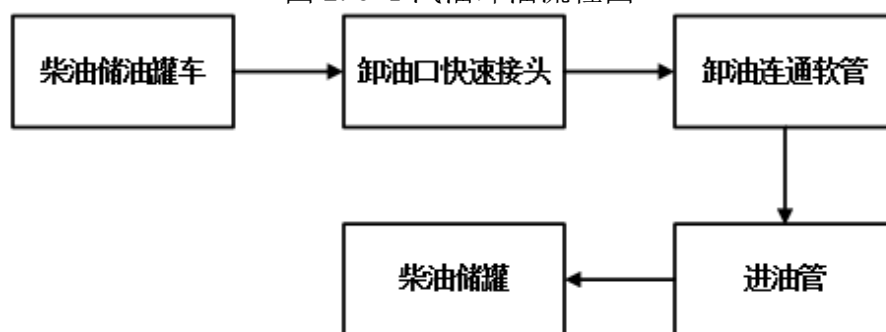
图 2.6-2 柴油卸油流程图
