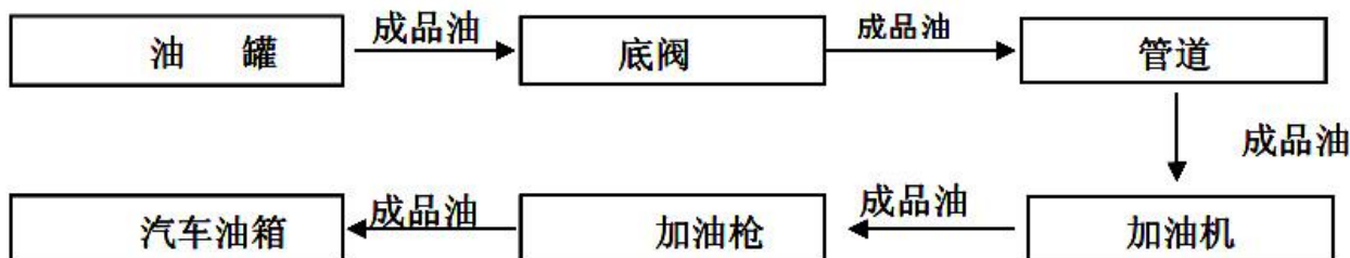
图 2.6-3 柴油加油工艺流程示意图
