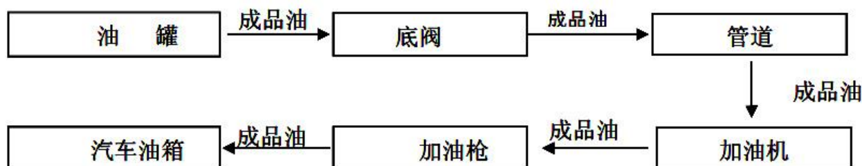
图 2.6-3 柴油加油工艺流程示意图
