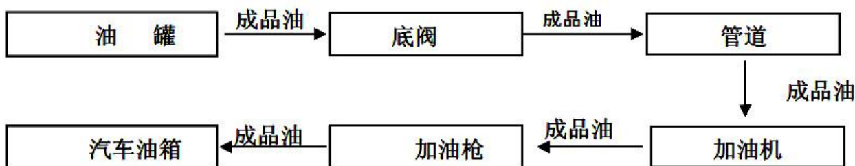
图 2.6-3 柴油加油工艺流程示意图
