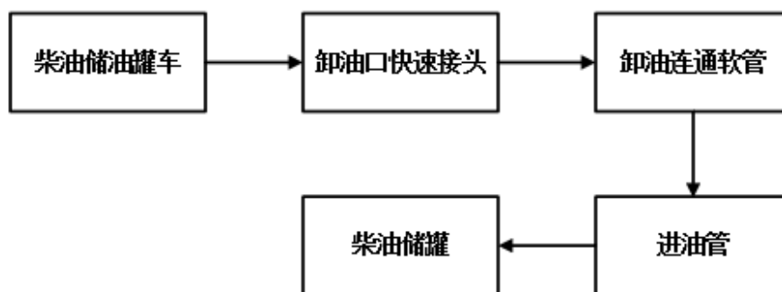
图 2.6-2 柴油卸油流程图
