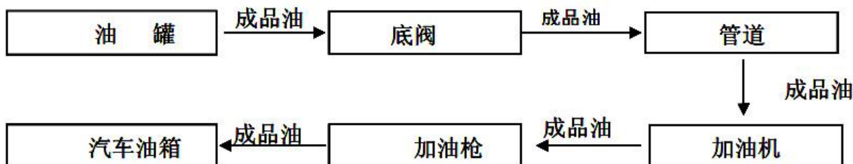
图 2.6-3 柴油加油工艺流程示意图
