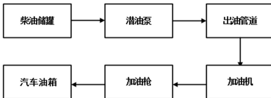
图 2.6-4 柴油加油流程图
