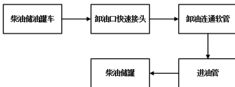
图 2.6-2 柴油卸油流程图
