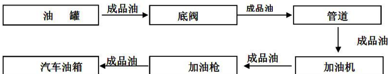
图 2.6-3 柴油加油工艺流程示意图
