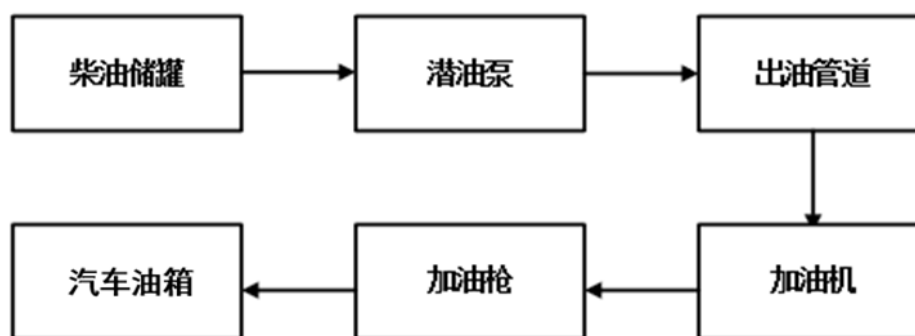
图 2.6-4 柴油加油流程图
