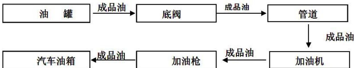
图 2.6-3 柴油加油工艺流程示意图
