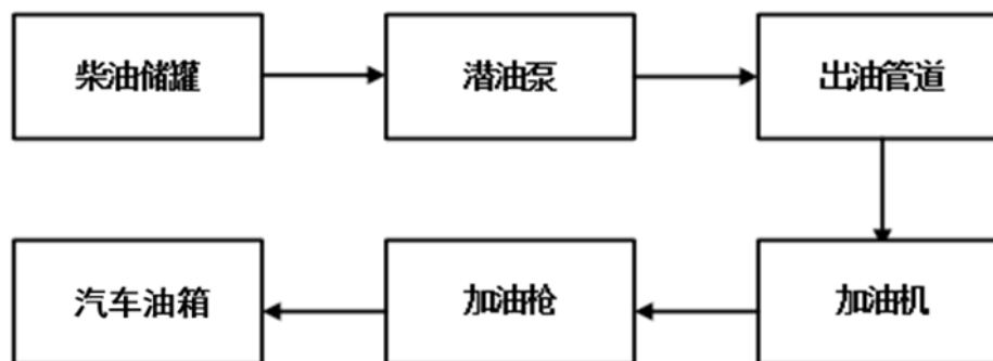
图 2.6-4 柴油加油流程图
