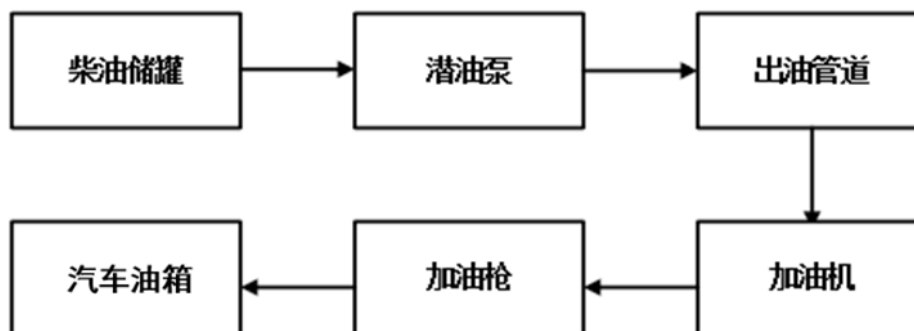
图 2.6-3 汽油加油流程图
