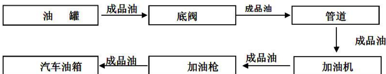
图 2.6-3 柴油加油工艺流程示意图
