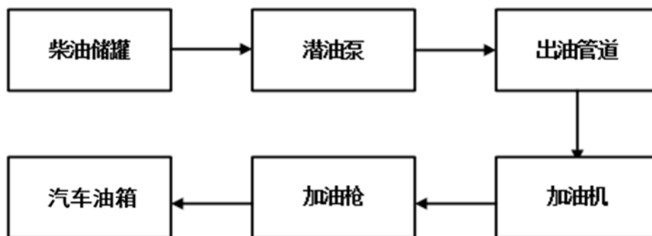
图 2.6-4 柴油加油流程图
