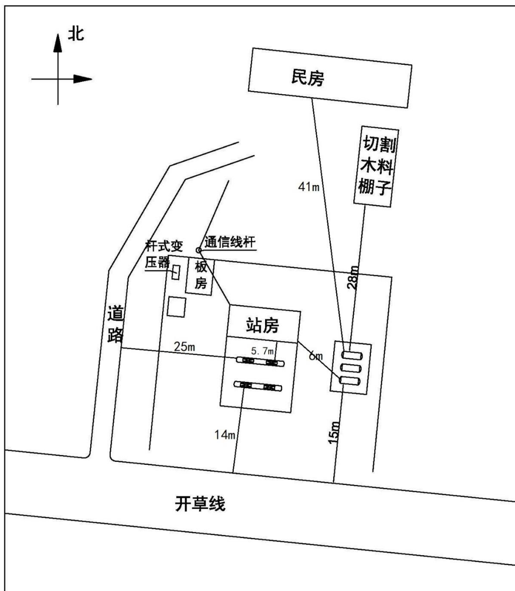
图 2.3-1 加油站周边环境和总平面布置示意图
